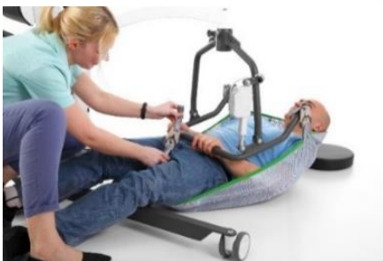
Afbeelding 33 - Een tilband aan de buitenste pinnen van het juk bevestigen
