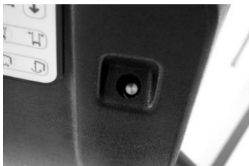
Afbeelding 14 - Handmatig veilig dalen met de sleutel voor nooddaling
