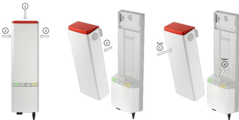
Afbeelding 16 - De noodstop ontgrendelen
