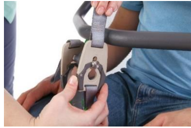
Afbeeldin 27 - Een tilband aan de buitenste pinnen van het juk bevestigen
